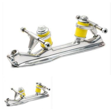
Telaio per pattinatori di medio livello o pre agonistico, le solette sono in alluminio e la regolazione dello sterzo e? con dado autobloccante; doppia vite freno di sicurezza, puntalino crociera fisso in acciaio. Sospensioni in gomma naturale in 2 durezza.
