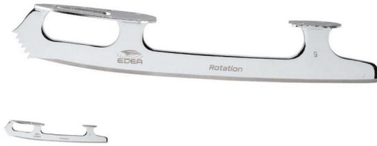
Realizzata in acciaio al carbonio con brillante finitura cromata Rocker (profilo) 8' per maggiore manovrabilità Raggio di curvatura  $\frac{1}{2}$ ' offre un buon compromesso tra tenuta dei fili, scorrevolezza e velocità. 6 denti dritti e ben definiti per facilitare le puntate e migliore presa sul ghiaccio 4 fori ovali per un montaggio accurato.
